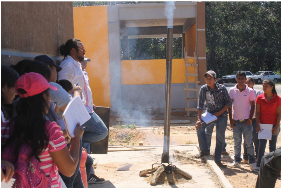
Figura 8. Bazuca para elaboración de fosfita a base de cáscara de café
