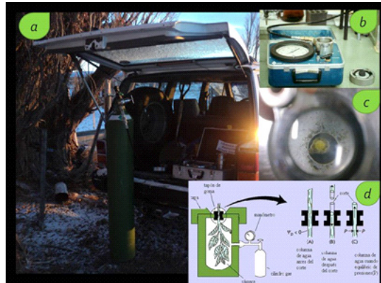
FIGURA 4. (a) y (b) Cámara de presión Scholander utilizada para medir potencial hídrico, (c) detalle de observación de la columna de agua de la sección de tallo, (d) gráfica ilustrativa de medición del potencial hídrico
