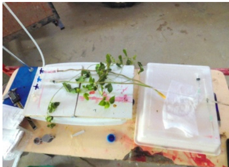
FIGURA 6. Dispositivo para medición de conductividad hidráulica realizado en lúpulo
