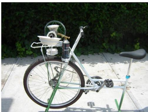
**Figura 9. Bicimaquina extractora de aceite. Solicitada para llevarla con los productores**
